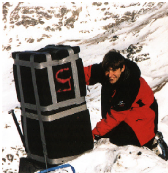
Eric Van Lancker d'IAV Engineering installant un microphone infrasonore, l'un des éléments d'une station fixe Arfang destinée à analyser l'environnement infrasonore ambiant et à prévenir des avalanches.
