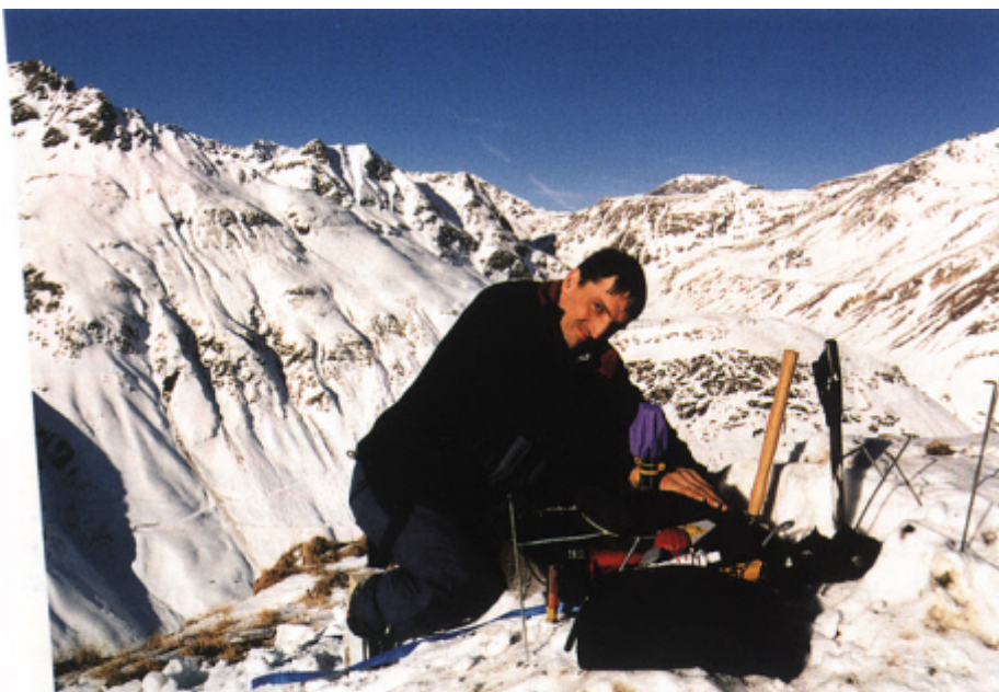
Vincent Chritin, créateur d'IAV Engineering installant un FlowCapt, une station de mesure automatique du vent et du flux de neige.
